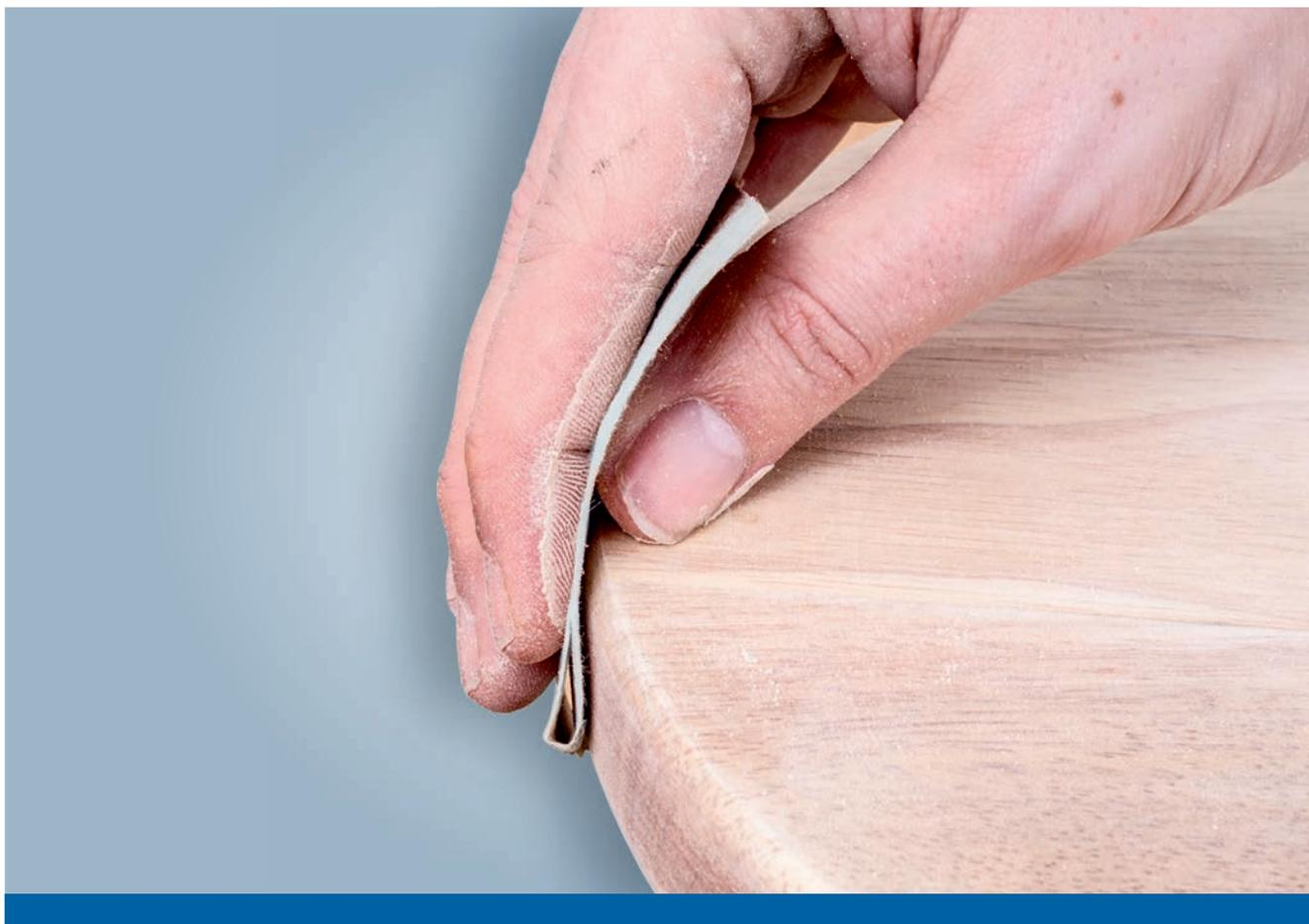
Материалы серии 140 SiC подходят для шлифования дерева и обработки шпона. Зерно карбида кремния обеспечивает тонкое удаление материала и равномерность риски, а открытая насыпка и стеаратный верхний слой продлевают срок службы, предотвращая засорение.
