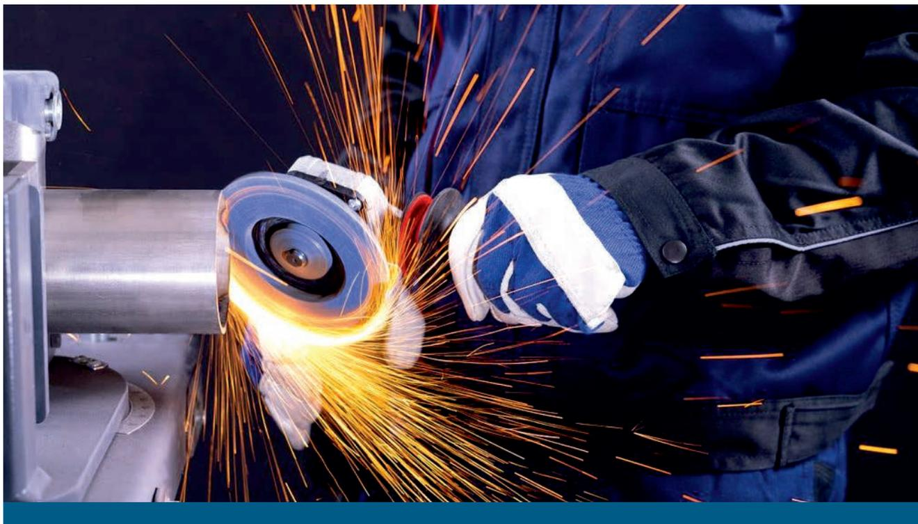
Лепестковые круги серии 915 (100% цирконий) предназначены для шлифования металла и нержавеющей стали. Высококачественные абразивные тканевые лепестки ровно прикрепленные на стекловолоконных подкладках, делают эту серию пригодным для сглаживания сварных швов, выравнивания поверхности и скругления кромок с отличной производительностью и высокой скоростью среза.
