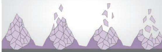
Керамическое зерно этой линии обеспечивает длительный срок службы острых краев, что дает более высокие результаты финишной обработки поверхности. Продукты этой серии идеально подходят для шлифования любых материалов, включая лаки антискретч, электрофорезные покрытия, грунты и композитные материалы, что устраняет потребность в специальных абразивах.
