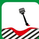
2. Если следы коррозии не получается удалить полностью – нанести преобразователь ржавчины.
