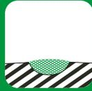
Для начала, если это необходимо, можно снять излишки лака при помощи наждачной бумаги зернистостью P2000. Для удобства можно обернуть наждачную бумагу вокруг небольшого резинового бруска и шлифовать лак вдоль повреждения с небольшим нажимом. Место шлифовки рекомендуется слегка смочить водой. Сравнить лак полностью с поверхностью кузова не нужно, т.к. можно повредить краску рядом с местом шлифовки.
