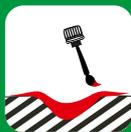
4. Для защиты от коррозии и выравнивания высоты покрытия нанести 1-2 слоя грунта на место скола. Дать высохнуть 20-30 минут при температуре 20°C. Излишки грунта удалить наждачной бумагой.
