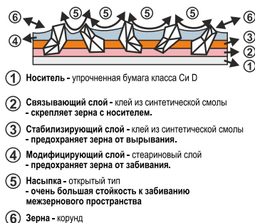
Строение абразивного материала K555, открытого типа со слоем стearина.
